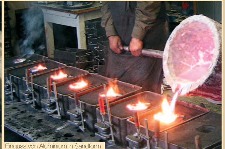
Einguss von Aluminium in Sandform
