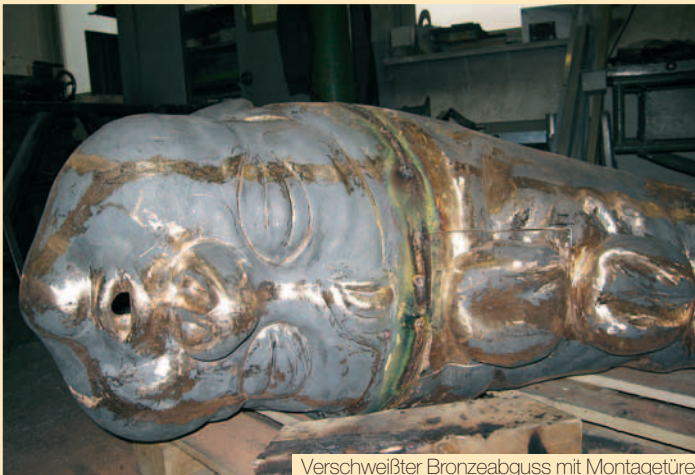
Verschweißter Bronzeabguss mit Montageturm
